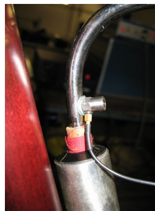
Abbildung 3: Beschleunigungssensor am S-Bogen.
