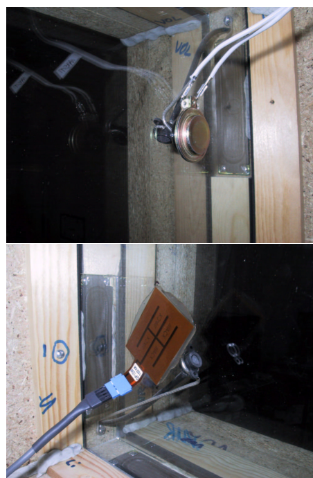
Abbildung 1: Shaker und Piezoelement am Fenster.
